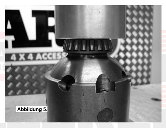
☐ Drehen Sie den Air Locker. Pressen Sie das mit dem Air Locker Kit ausgelieferte Walzenlager auf den Lagerzapfen, der sich auf der Seite des Tellerrad-Flanschs befindet (die Differentialseite, auf der auch das Dichtringgehäuse montiert wird), bis auch dieses fest auf dem Lagerzapfen sitzt.
