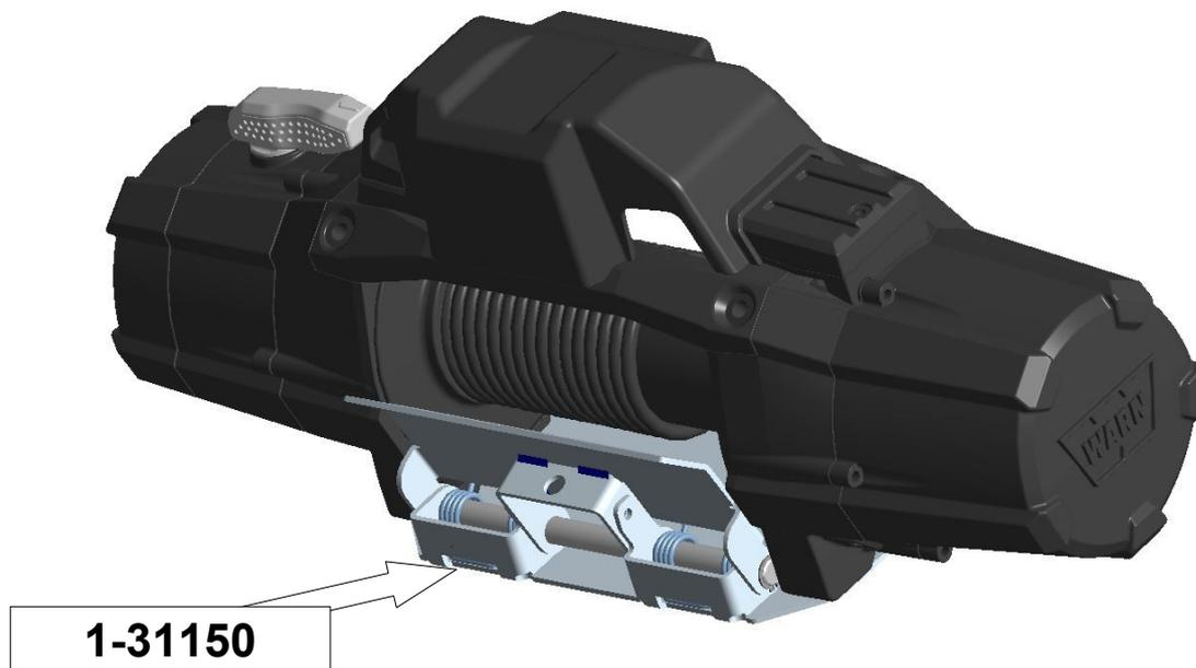
**Hier sehen sie die fertig montierte Seildruckplatte
